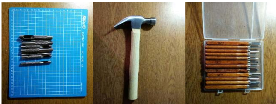
图 1 铊子、垫板、锤子、雕刻刀 拍于邬红芳工作室工具
